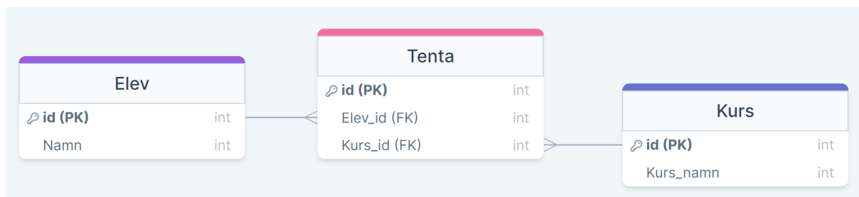
Figur 6. MariaDB databas med Tabellerna Elev, Tenta och Kurs. Elev innehåller kolumnerna id och namn. Kurs innehåller id och kurs_namn. Tenta innehåller id, elev_id och kurs_id varav de två sista refererar till värden från tabellerna Elev och Kurs. Primary keys benämns PK och foreign keys benämns FK.
